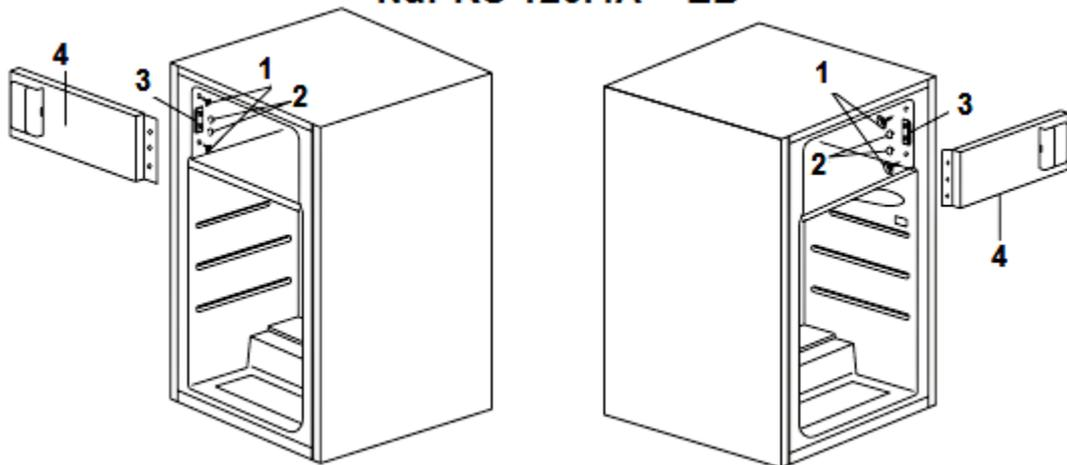
1. Entfernen Sie die zwei Plastikschrauben (1) auf der linken Seite.
