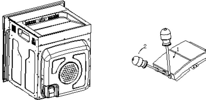
**Anschlussdose öffnen:** Zum Entriegeln Schraubenzieher ansetzen (1) und leicht nach unten bewegen (2).
